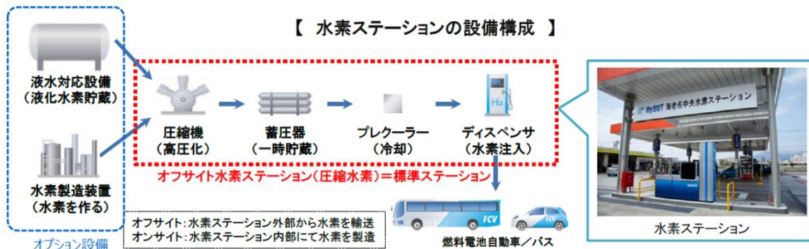
図表 23 水素ステーションの設備構成 (イメージ)
