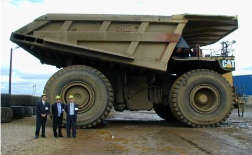
写真 2 露天掘りセクションで使用される 400 t トラック (筆者撮影)
