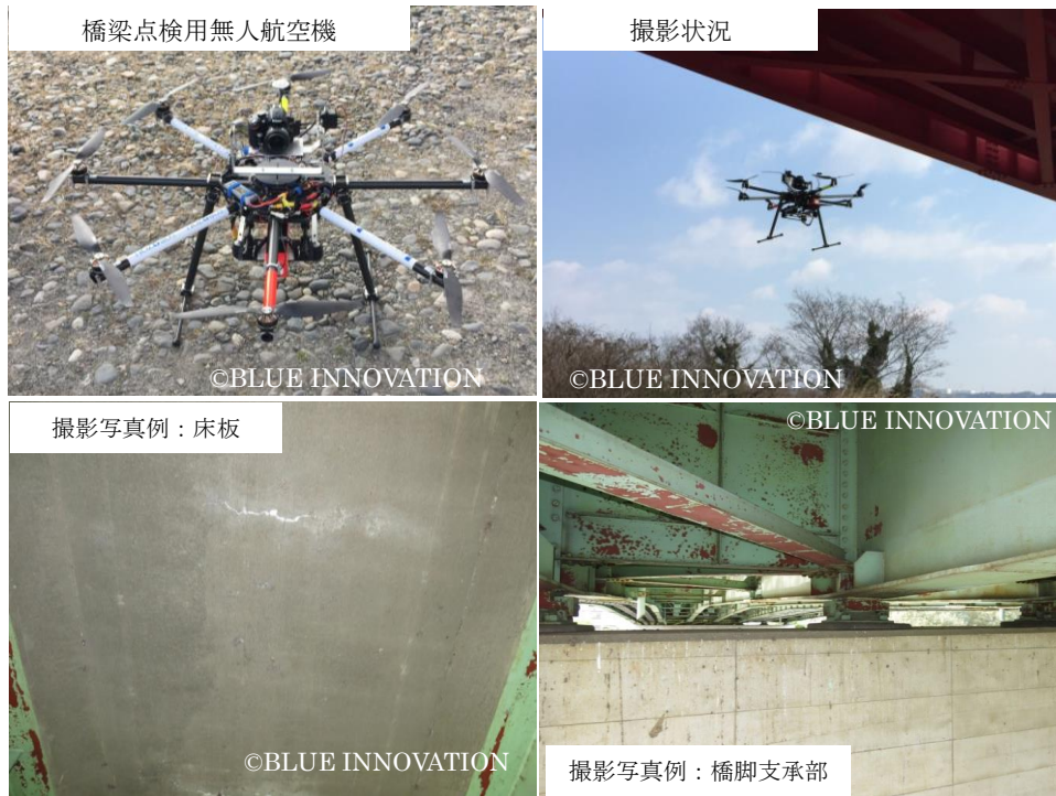
図10 無人航空機を活用した橋梁点検の成果例
